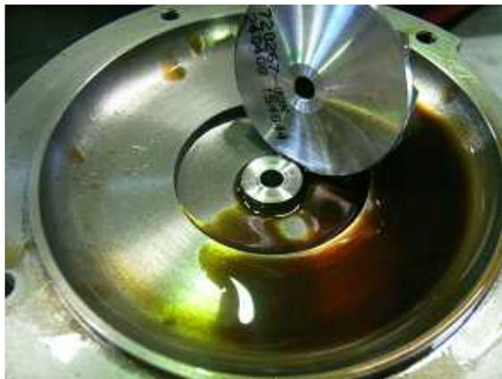
ブリーザーホースからターボ吸入側へ瞬時に、多量のオイルを吸込み、排気管から白煙、オイル漏れとなり、ひどい場合は燃焼室内でプラグがかぶり、出力不足の現象が発生します。
