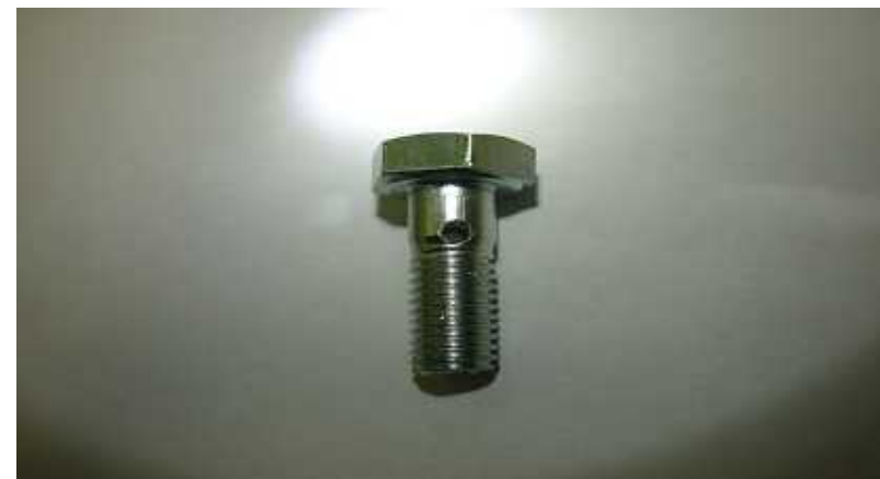
弊社付属ユニオンボルト(エンジン側2.0mm*2) 写真2
