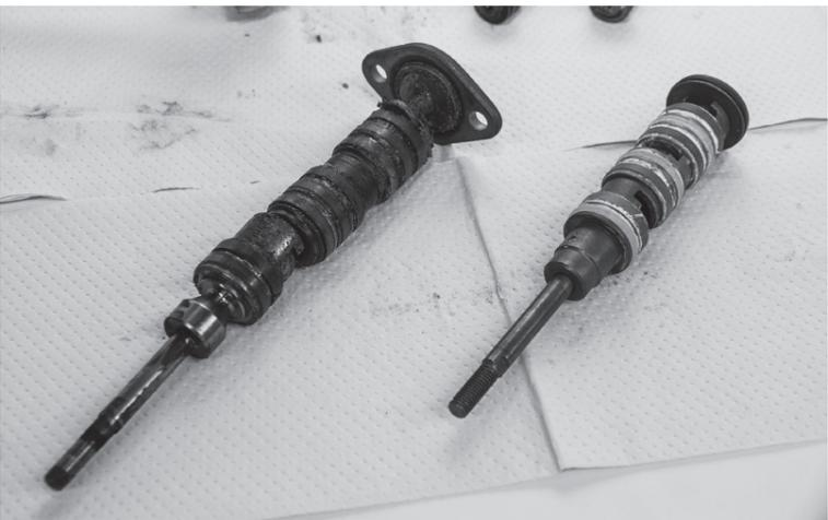
▲▶エアシリンダーの中で動くピストン。このピストンのストロークで可変ノズルの開け閉めが行なわれる。右の新しいピストンには白いグリスもしっかりと塗られているが、左の古いピストンは真っ黒。グリスはオイルと相性が悪く、混ぜるとぼろぼろになってしまう。ぼろぼろになったグリスは、むしろピストンの動きを鈍くさせ、最終的には正常に動かなくなる。だがエアドライヤの定期交換をきちんと行なう=日常のメンテナンスをしっかりと行なうことでその危険は回避できそう
