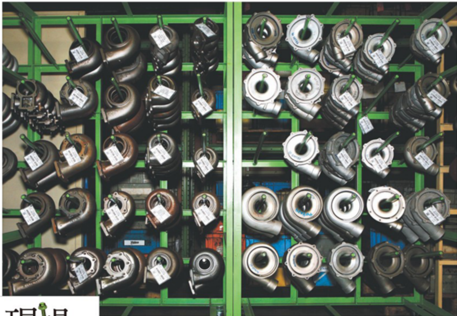
真っ黒いペアリングが付いているのはT/Cによるリビルド品。ペアリングはコーティングされ、軸と滑らかに磨かれている。いい状態が選り好みである。磨かれてくれている。
