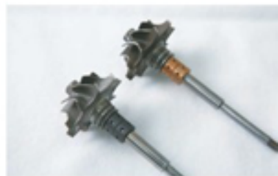
真っ黒いペアリングが付いているのはT/Cによるリビルド品。ペアリングはコーティングされ、軸と滑らかに磨かれている。いい状態が選り好みである。磨かれてくれている。
