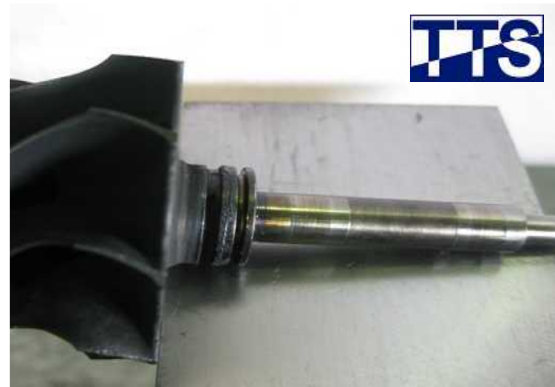
シャフトジャーナル部、ベアリングの齧り、異常磨耗
