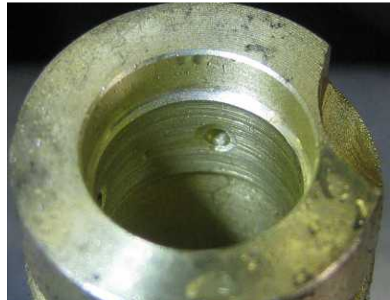
シャフトジャーナル部、ベアリングの齧り、異常磨耗
